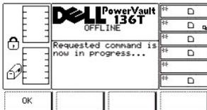
図 54. Command > Drives > Unload > Command in Progress ダイアログ
